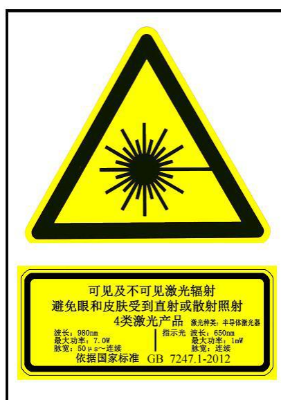
图 5.1 张贴于激光工作区入口处的警告标志
